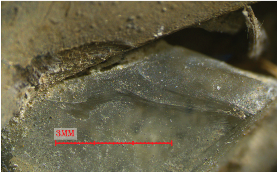
איור 23: נקודת פגיעה של גוף גלילי קשה (קליע) בגוף המתכת והמשך התנועה (שריטה) על גבי זגוגית המצפן, מיקרוסקופ סטריאוסקופי Leica M205C (ניר פינקלשטיין)
