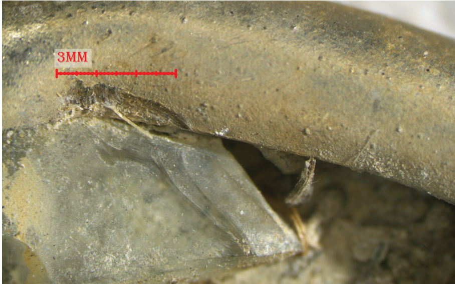
איור 24: תנועת הגוף הגלילי הקשה (קליע) על שרידי זגוגית המצפן ביחס לנקודה שבה נפרץ גוף המתכת, מיקרוסקופ סטריאוסקופי Leica M205C (ניר פינקלשטיין)
